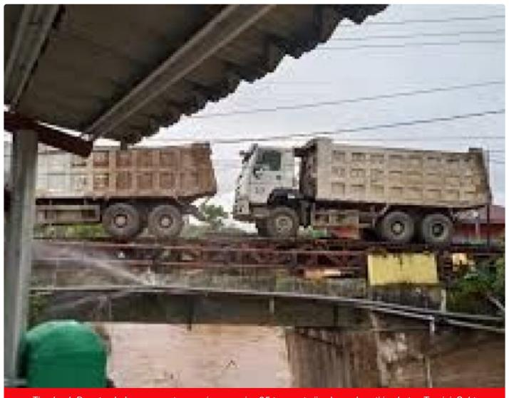
Tiga buah Dum truck dengan muatan masing - masing 25 ton saat uji coba melewati jembatan Tamiai, Sabtu (06/01/2023)
